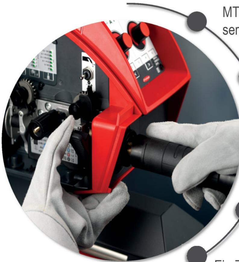
MTG und MTW Schweißbrenner sind serienmäßig mit dem FSC Anschluss ausgestattet
