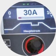
/ 4,3-Zoll-Farbdisplay mit einfacher und intuitiver Menünavigation ermöglicht unkompliziert das Einstellen von Parametern.
